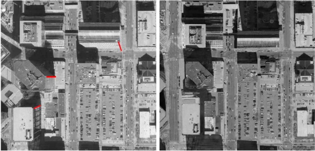
Şekil 6.1. Ortho olmayan görüntü (sol) - Ortho yapılmış görüntü (sağ)
