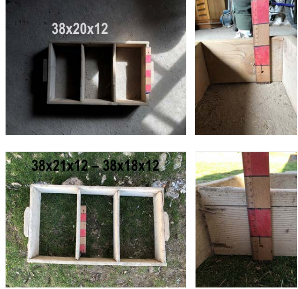
Şekil 12: Ahşap kerpiç kalıpları (2019).
